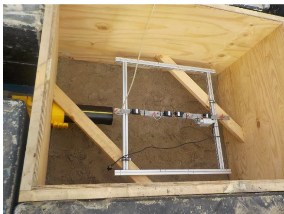
Foto 4 en Foto 5 De positie van de vonkontstekers.
