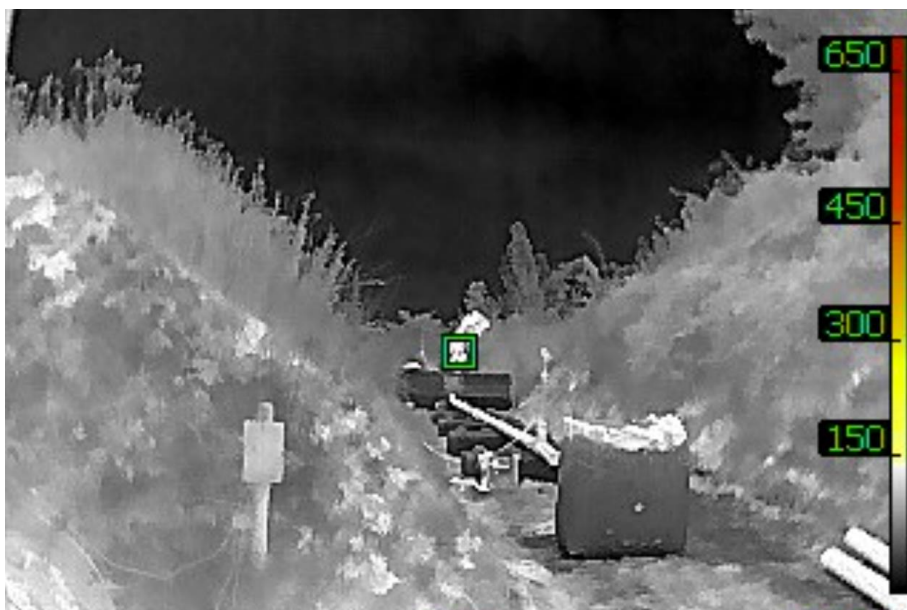
Foto 17: Warmtebeeld meting 27 (15m³/h H2)
