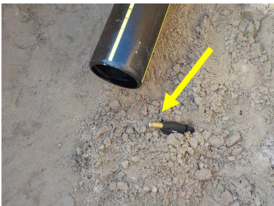
Foto 12 met de positie van de gasbrander als ontsteekbron en Foto 13 de vonkontstekers als ontsteekbron
